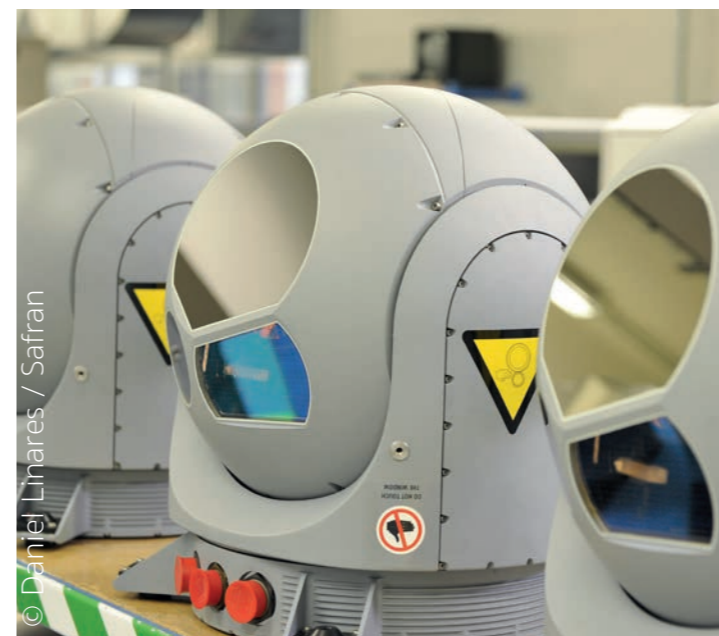
Boule gyrostabilisée, produite par Safran Electronics & Defense à Dijon. Conçus pour des missions de surveillance, de recueil de renseignements, de sauvetage et montés sur avion, hélicoptère et drone.
