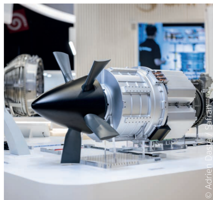
EngineUS, produit par Safran Electrical & Power à Niort. Moteur électrique destiné à des avions 100% électriques (ex: eDA40) et à accompagner l'hybridation (ex: EcoPulse, electra).
